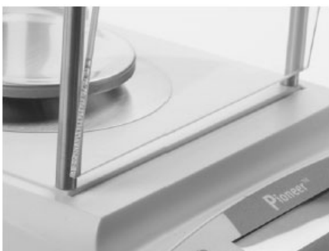
2) Установите стенки: вставьте нижний край в паз, затем прижмите верхний край до срабатывания защелки.
